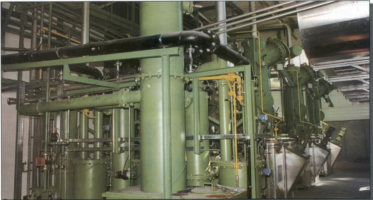
Der Graphitierungsprozeß von imprägnierten Elektroden ist ein zyklischer Prozeß, der je Ofen über einen Zeitraum von ca. 50 h teer- und staubbeladenes Abgas erzeugt. Von den 8 Öfen sind gleichzeitig 2 Öfen im Gasbetrieb. Die Abgase dieser beiden Öfen werden in je einer Gasreinigungsanlage gereinigt. Eine dritte Anlage befindet sich im Standby-Betrieb.
